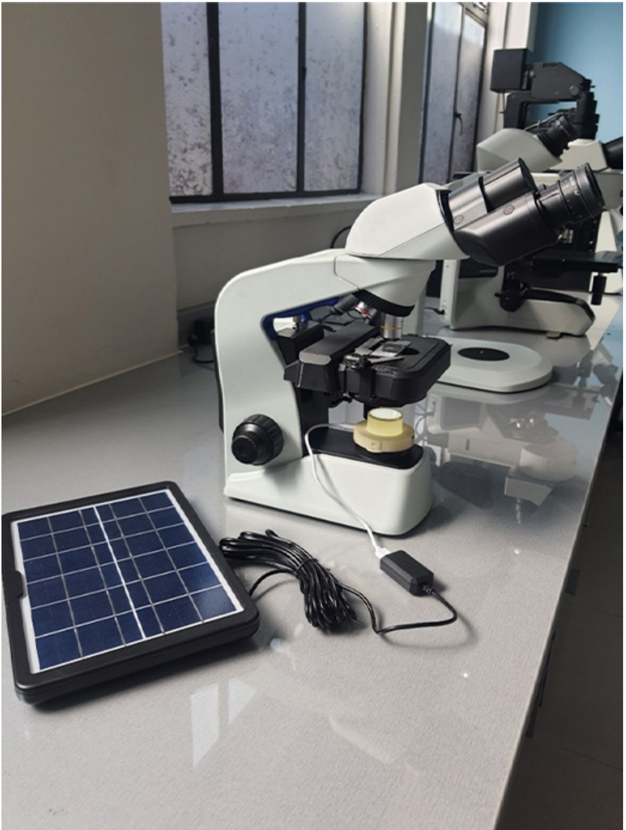
Figura 3. Imagem da luz de LED USB instalada no microscópio CX23 e conectada a uma fonte de energia de painel solar.
